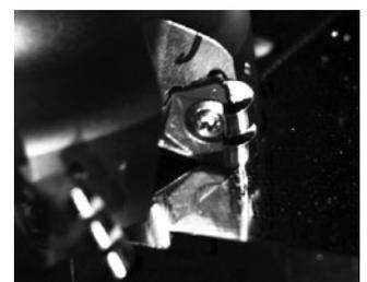
Должным образом скрученная стружка (Фотография получена с помощью скоростной фотокамеры)
