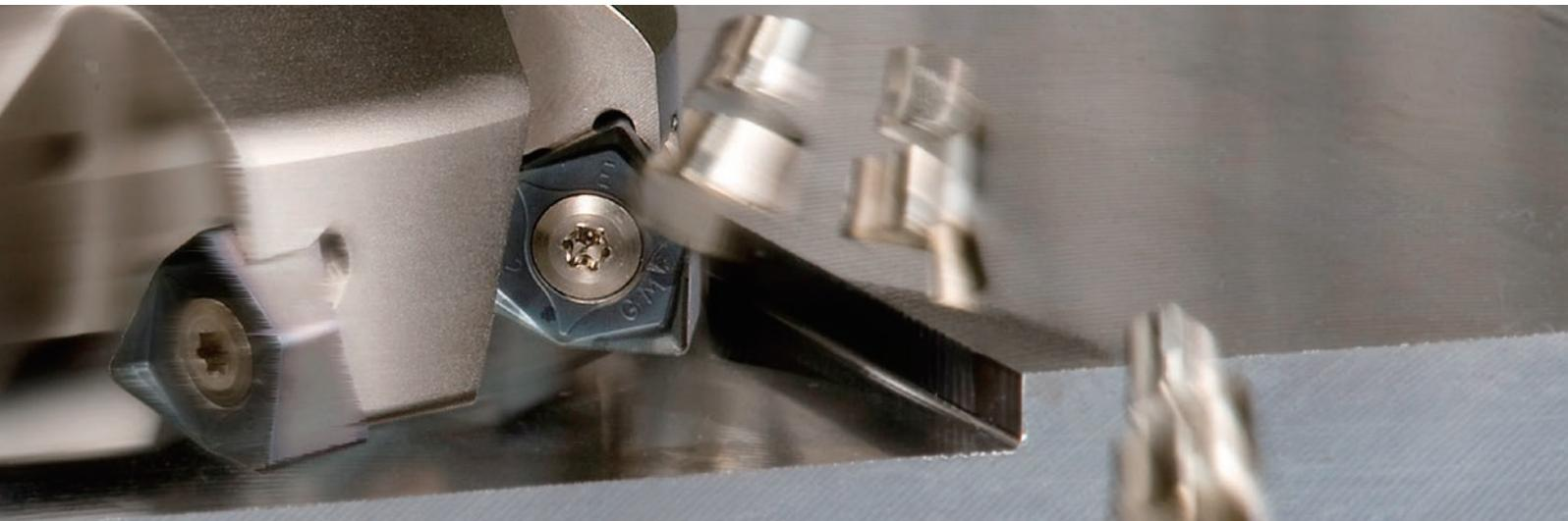
Экономичная двусторонняя пластина с 6 режущими кромками, отличающаяся превосходной прочностью за счет конструкции пластины большой толщины
